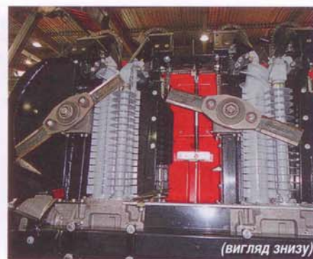
Вальці для протягування та розщеплення стебел і подрібнювальні ножі жатки Geringhoff Roto-Disc
