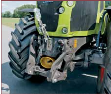
Передня навісна система вантажопідйомністю до 6,5 т компактно вмонтована у напівраму трактора
