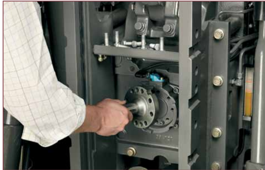
Швидка та легка заміна хвостовика механізму відбору потужності
